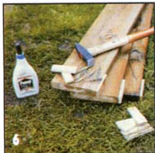
6 На концах досок к их кромкам приклеивают (или прибивают) деревянные прокладки.
