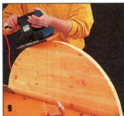
2 При скруглении лицевой кромки столешницу крепят на верстаке. Сначала кромку обрабатывают виброшлифовальной машинкой, используя шкурку зернистостью 40–60, а затем — шкурку зернистостью 120.
