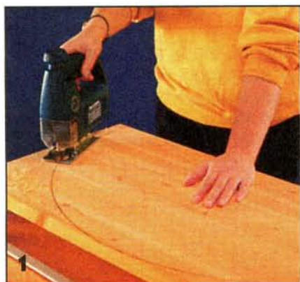
1 Столешницу полукруглой формы вырезают электролобзиком из мебельного щита толщиной 30 мм, предварительно разметив её контуры.
