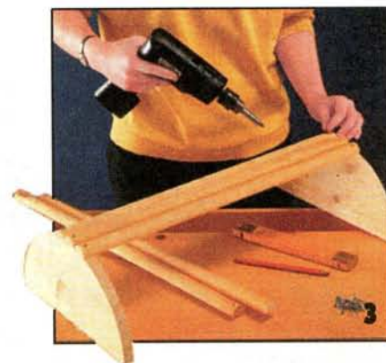
3 К горизонтальным плитам стойки стола крепят рейки полукруглого сечения на клею и шурупах. Отверстия под шурупы сверлят заранее.
